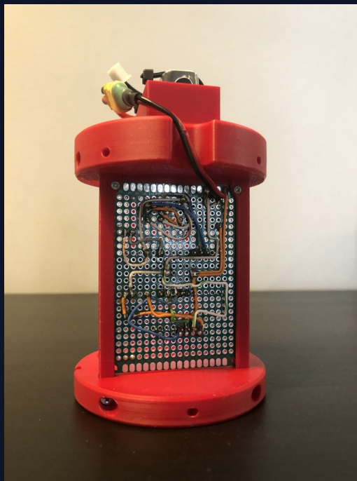
Πίσω όψη — χειροποίητη καλωδίωση
